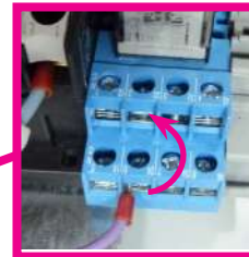
Для солевого электролизера: Инверсия логической схемы управления НР / НЗ
